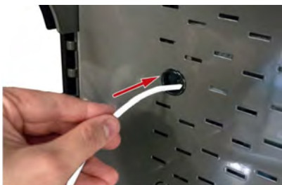
Fig. 12: Sistemazione del cavo di collegamento dietro la parete posteriore
