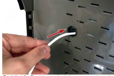
Şekil 12: Bağlantı kablosunu arka duvarın arkasına yerleştirin
