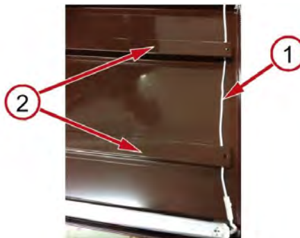
Sl. 10: Sprovođenje kabla za povezivanje LED traka (1), šina za učvršćivanje (2)
