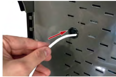
Abb. 12: Verbindungskabel hinter Rückwand versteuen
