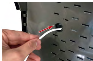
Sl. 12: Sprovođenje kabla za povezivanje iza zadnjeg zida
