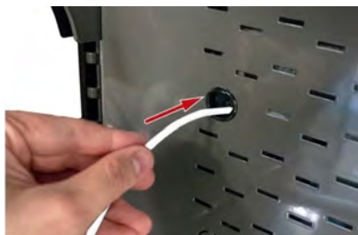
Fig. 12: Passage du câble de branchement par la face arrière
