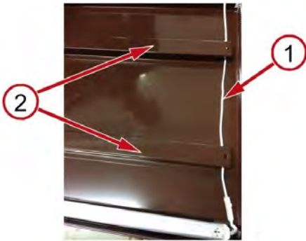
Şekil 10: LED çubuk kablo kılavuzu – bağlantı kablosu (1), destek rayı (2)
