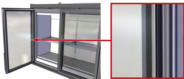
Fig. 21: Junta de puerta (1)
