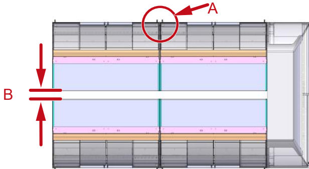
Joon 5: Minimaalne vahekaugus seadmete ühendatud paigalduse korral
